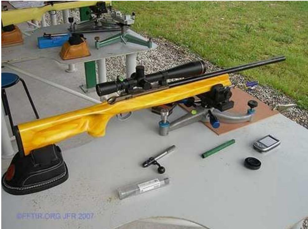
Crosse Cicognani Bench avec trou de pouce, mécanisme Anschütz 2013, lunette Leupold grossissement 40, pied avant coussin arrière standard
