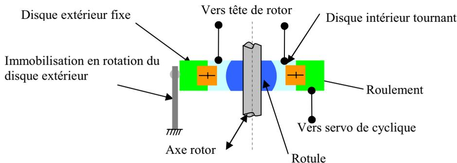
Lorsque le plateau cyclique est horizontal, si l'on considère les biellettes en liaison avec la tête de rotor, celles-ci ne se déplacent pas verticalement. Aucune action n'est transmise à la tête de rotor.
