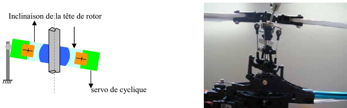
Le plateau cyclique joue le rôle de la commande d'ailerons et de la commande profondeur.
